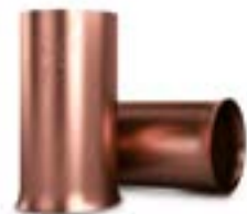
AT-072NCXX: Adaptadores de cobre de diámetro variable donde XX indica los mm 2 del cable final. Se utilizan para incrementar la sección de un conductor de forma que acopla en un molde diseñado para ese cable XX de mayor tamaño. XX = 50, 70, 120...
