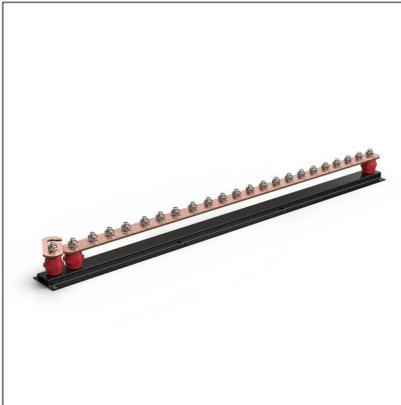
Barra de tierra de 20 vías, realizada con pletina de 50 x 5 mm, que permite la conexión de conductores con terminales de conexión tipo anillo de cobre estañado (por ejemplo, AT-093K).
