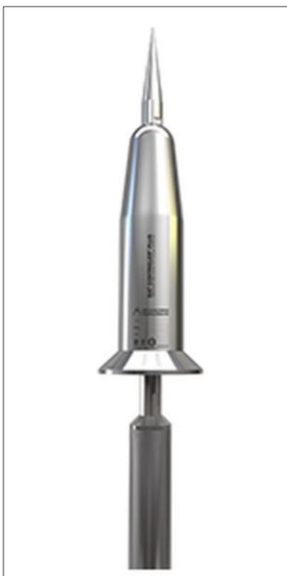
Tiempo de avance en el cebado: 60 µs obtenido de acuerdo a los ensayos de la norma UNE21186:2011. Es el pararrayos con el mayor radio de protección posible, ya que según esta norma éste es el mayor tiempo de avance que se puede aplicar para calcular la zona protegida por un pararrayos con dispositivo de cebado.
