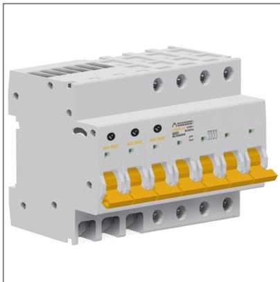
Los protectores de la serie IGA TEST cortan la línea cuando detectan una sobretensión permanente (por ejemplo, fallos de neutro), protegiendo así los equipos instalados aguas abajo.
