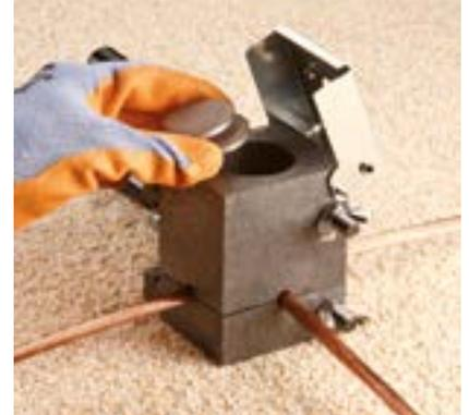
Insérer et connecter l'initiateur électronique **APLIWELD®-E**
