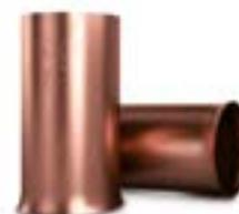
**AT-072NCXX** : Manchons adaptateurs en cuivre de diamètre variable, où XX indique les mm<sup>2</sup> du câble final. Ils sont utilisés pour augmenter la section d'un conducteur, afin qu'il s'adapte au moule conçu pour des câbles de plus grande taille. XX = 50, 70, 120...
