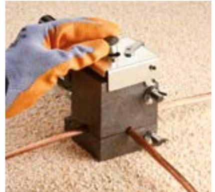
Appuyer simultanément sur les deux boutons du **Kit APLIWELD®-E**
