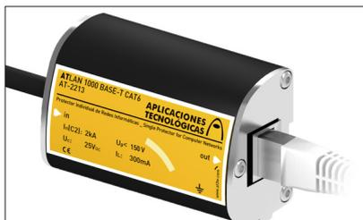
Los protectores contra sobretensiones ATLAN están diseñados especialmente para evitar fallos en las transferencias de datos entre equipos dentro de una red. Protegen las entradas de los circuitos electrónicos de las tarjetas de red contra los daños causados por las corrientes transitorias.
