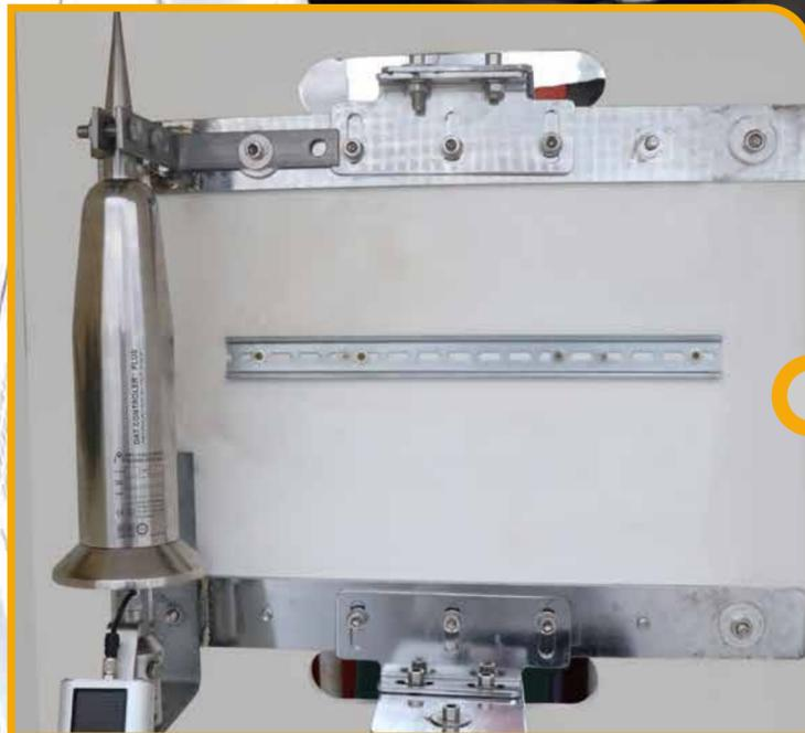
Aplicación directa de **5 impulsos de corriente 10/350  $\mu$ s** con una corriente de pico de 250 kA y energía específica mayor a 15MJ/ $\Omega$ . Tras el test, el pararrayos mantiene su dispositivo de cebado inalterado.
