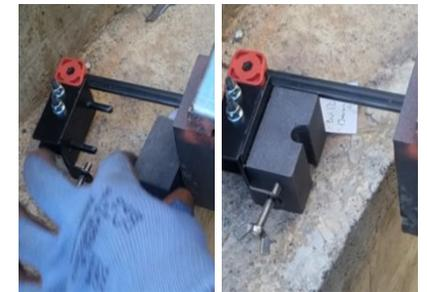
Se combinan los accesorios según el tamaño de la varilla (o la pica) y el molde según la conexión y el tamaño del cable. Es un concepto similar al molde múltiple porque con un reducido número de piezas se pueden realizar muchas conexiones diferentes.
