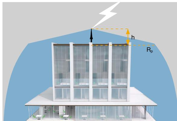
> RAYONS DE PROTECTION EN MÈTRES ( $R_p$ ) DAT CONTROLLER® PLUS ET DAT CONTROLLER® PLUS + AT-REMOTE TESTER
